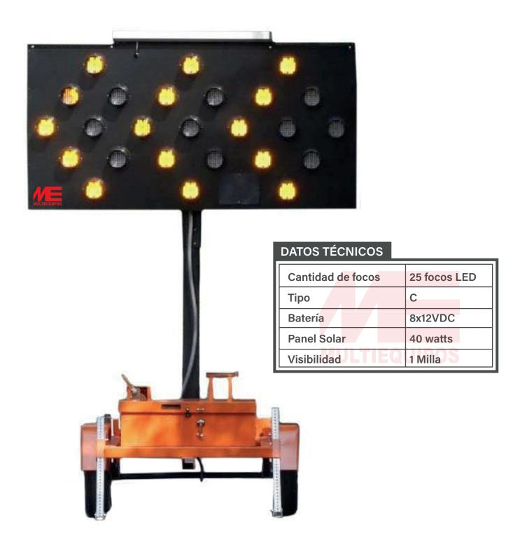
Los tableros de señalización AMSIG estan equipados con 25 lámparas LED, un panel solar de alto voltaje y un banco de baterias libres de mantenimiento. Diseñadas para adecuarse a carreteras y zonas urbanas, gracias al remolque sobre el cual se encuentran montadas y su amplia visibilidad, las flechas de señalización AMSIG fomentan la conciencias de los automovilistas y la seguridad en zonas de trabajo.
