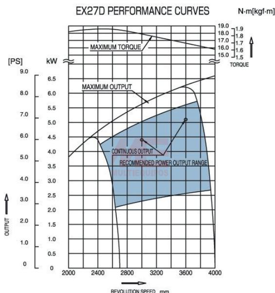
las curvas de potencia se corrigen a la condición atmosférica estándar del nivel del mar y se desarrollan a partir de motores de prueba equipados con limpiador de aire estándar y silenciador
